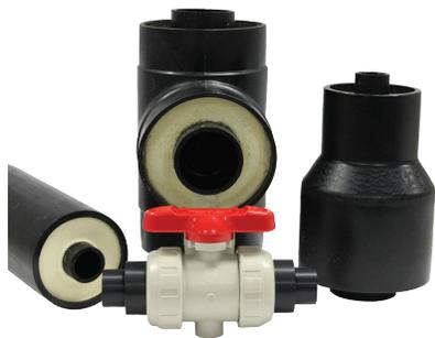
O sistema de tubulação COOLSAFE™ oferece soluções com boa relação entre custo e benefício para instalar tubulação revestida em uma ampla gama de aplicações. O sistema consiste de uma camada interna de polietileno, um núcleo isolante em poliuretano e uma camada externa em polietileno. A mão de obra de instalação é drasticamente reduzida, pois os tubos e conexões são previamente revestidos na fábrica.
